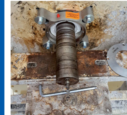
Enddeckel und O-Ring an Maschinenwand montiert.
